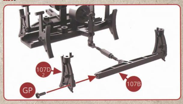
Positionnez le sabot droit 107D (2) à l'extrémité droite du triangle de frein 107B et assemblez-le avec une vis GP.
