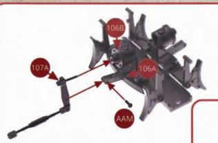
Positionnez le triangle de frein 107B sur la tringlerie 107A et assemblez-le avec une vis AAM.
