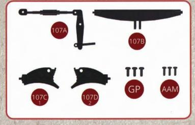
Début de l'assemblage de la tringlerie de freinage entre les bogies du tender
