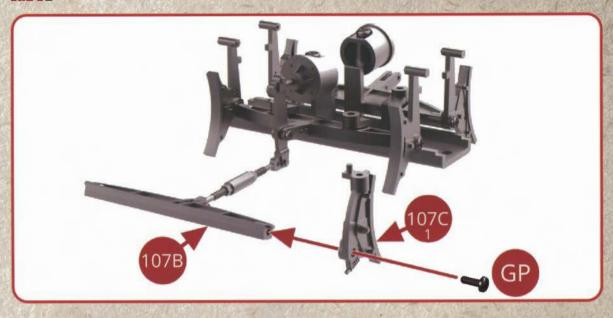
Positionnez le sabot gauche 107C (1) à l'extrémité gauche du triangle de frein 107B et assemblez-le avec une vis GP.
