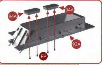
Positionnez deux trappes 94A sur le platelage supérieur 93A et assemblezles par le dessous avec quatre vis FP: voir les illustrations ci-contre et ci-dessous.
