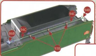
Sur le <u>côté droit</u> du tender, enfilez la tige de pivotement 94C dans trois supports de tringlerie 93B successifs puis dans la vanne 86B droite.
