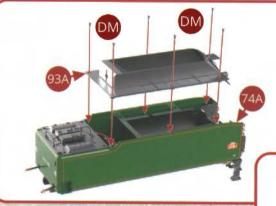
Positionnez l'ensemble formé par la rehausse de la soute à charbon et son platelage 93A sur la caisse du tender 74A et assemblez le tout avec six vis DM.
