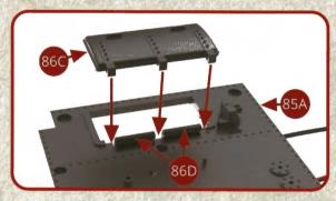
Placez la vanne de remplissage 86C sur le plateau arrière du tender 85A en la faisant entrer sur la charnière 86D.
