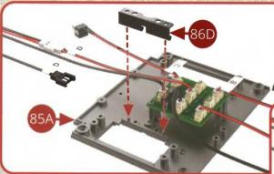
Positionnez la charnière de la vanne de remplissage 86D sur le plateau arrière du tender 85A contre le rebord de l'ouverture de la vanne et assemblez-la avec deux vis NP (voir les illustrations ci-contre et ci-dessous).
