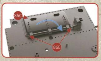
Vérifiez que l'ouverture et la fermeture de la vanne se font correctement et sans point dur.
