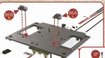
Positionnez les gonds gauche 86A et droit 86B sur le plateau arrière du tender 85A et assemblez-les par le dessous avec deux vis IP (voir les illustrations ci-contre et ci-dessous).
