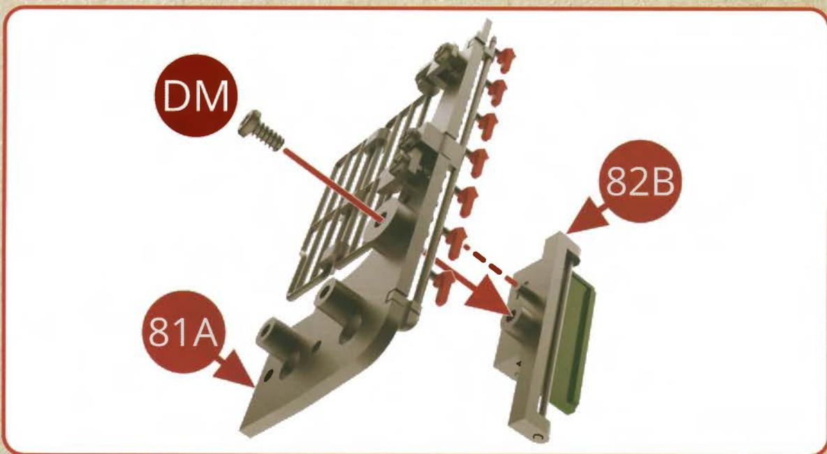
Assemblez le portillon droit du tender 82B sur le montant droit du tender 81A avec une vis DM.
