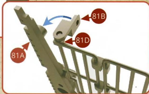
Présentez la charnière supérieure 81B de la grille pivotante sur le pivot supérieur et faites tourner le tout pour le présenter sur le montant 81A.
