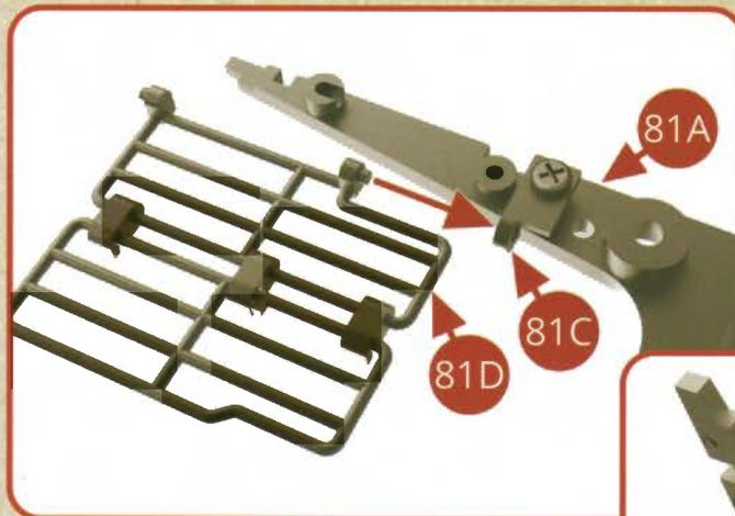
Poussez le pivot inférieur de la grille de protection 81D dans la charnière inférieure 81C.
