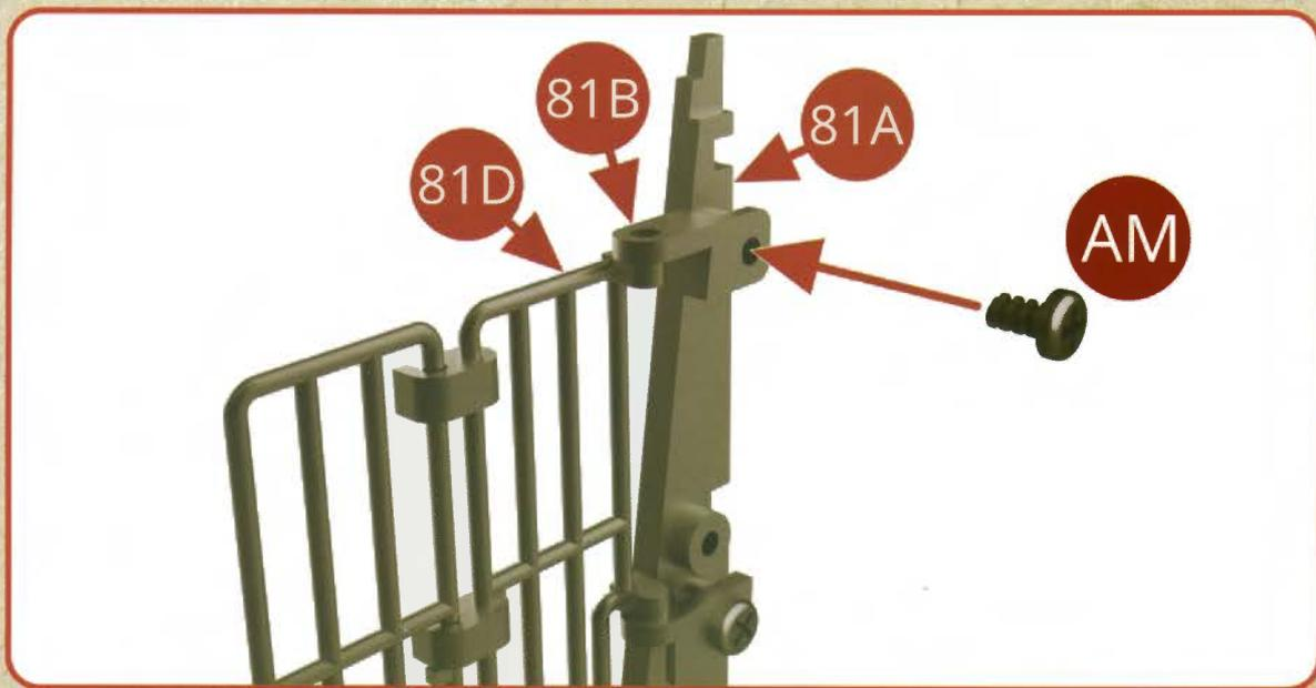
Assemblez la charnière supérieure 81B sur le montant droit 81A du tender avec une vis AM.
