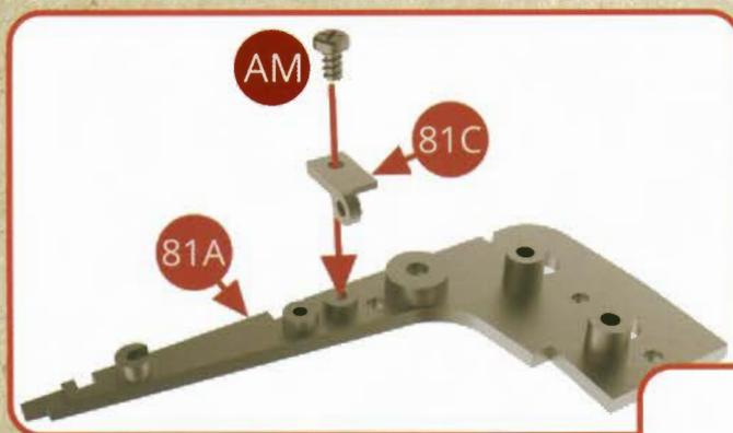
Présentez la charnière inférieure 81C sur le montant droit 81A et assemblez-les avec une vis AM.
