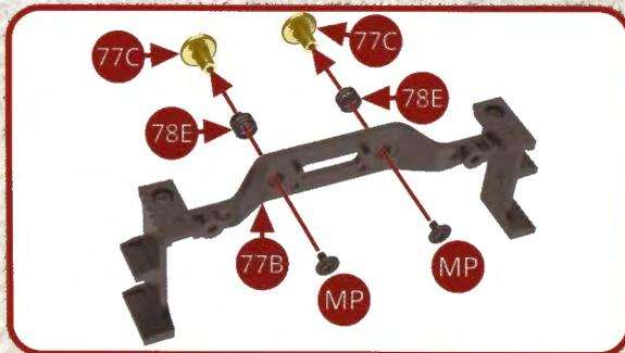
Poser les deux ressorts 78E sur les deux tampons 77C et mettez-les en place sur la traverse avant 77B. Assemblez-les avec deux vis MP.
