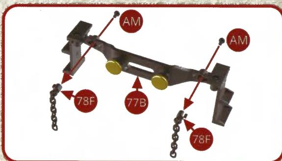
Positionnez les deux raccords avec œillets 78F sur la traverse avant 77B et assemblez-les avec deux vis AM.
