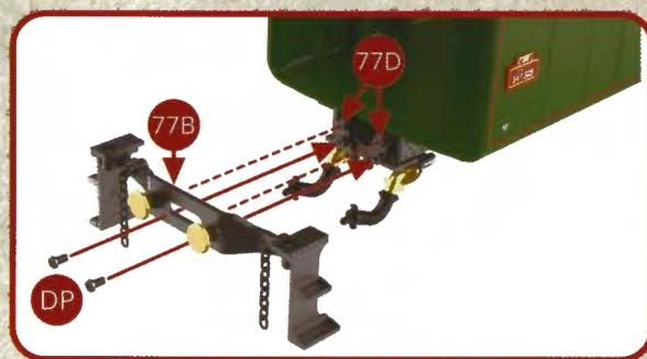
Positionnez la traverse avant ainsi équipée sur le support 77D et assemblez le tout avec deux vis DP.
