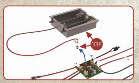
Détachez le fil électrique A 33F de la grappe de fils électriques et raccordez-le.
