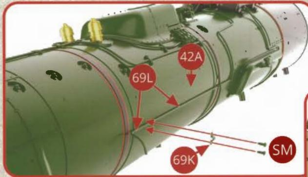
Assemblez la tubulure haute pression 69L sur le foyer 42A avec un cavalier 69K et deux vis SM. Assemblez la tubulure haute pression 69L sur la virole 39A avec un cavalier 69K et deux vis SM.
