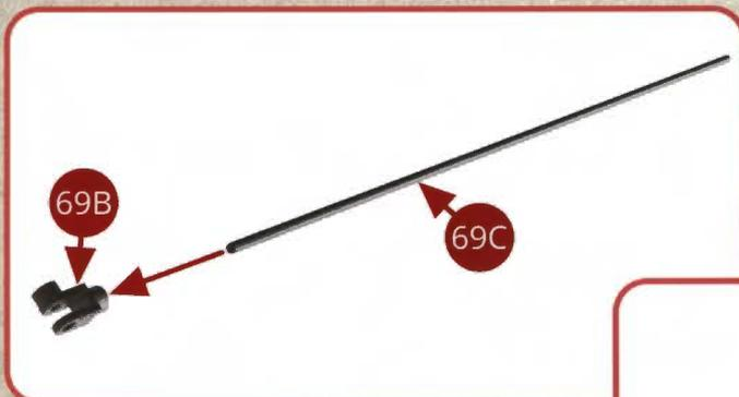
Positionnez la tringle de relevage de distribution 69C sur la fourche 69B.
