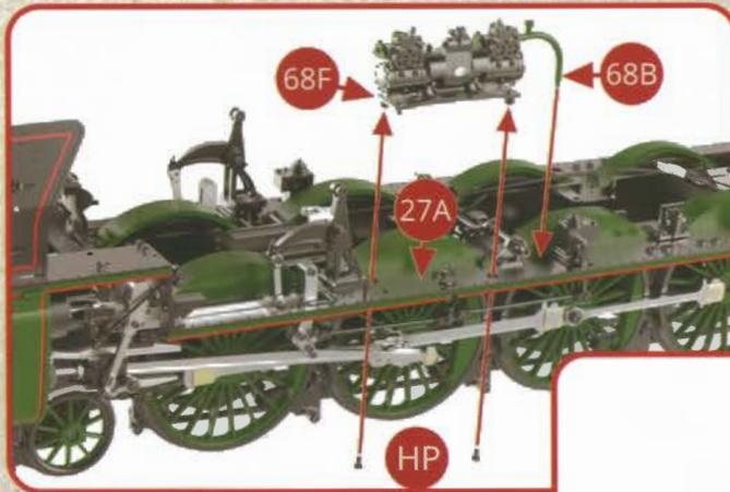
Positionnez la pompe et son socle 68F et 68A sur le tablier gauche 27A et assemblez le tout avec deux vis HP. Positionnez l'extrémité du raccord avec le tuyau 68B dans son logement sur le tablier 27A.
