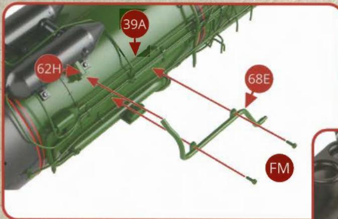
Positionnez le tuyau d'arrivée d'eau 68E sur le tuyau d'alimentation du réchauffeur 62H et sur la virole de chaudière 39A et assemblez avec deux vis FM.
