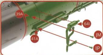
Présentez la conduite de vapeur 64L sur la virole de chaudière 39A et sur le passage de vapeur gauche 41A. Assemblez avec des vis JM et IP respectivement.
