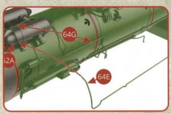
Positionnez la tubulure 64E sur le surchauffeur gauche 62A sur son embout placé à son extrémité avant, côté gauche.
