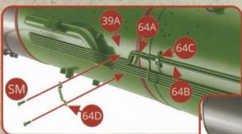
Confirmez la mise en place des tubulures 64A et 64B avec un cavalier supplémentaire 64D et deux vis SM.
