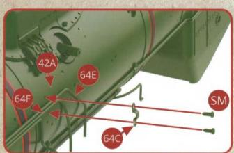
lci aussi confirmez la mise en place des tubulures 64E et 64F sur la virole de chaudière avec un cavalier supplémentaire 64C et deux vis SM.
