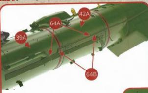
Détachez les étiquettes « 64A » et « 64B » des tubulures 64A et 64B et présentez-les en alignement sur les viroles de chaudière 39A et 42A. Assemblez-les avec deux cavaliers 64C et quatre vis SM (voir les illustrations ci-contre et ci-dessous).
