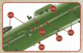
Les tubulures 64A et 64B sont assemblées sur les viroles de chaudière 39A et 42A au moyen de deux cavaliers 64D et 64C.
