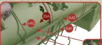
Confirmez la mise en place des tubulures 64E, 64F et 64G sur la virole de chaudière 39A avec un cavalier supplémentaire 64H et deux vis SM.
