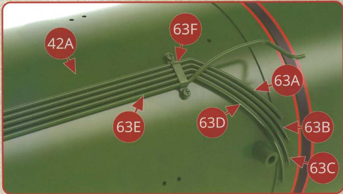
Vue de près de la mise en place des tubulures : 63A, 63B, 63C, et 63E, ceci dans l'attente de l'étape suivante.
