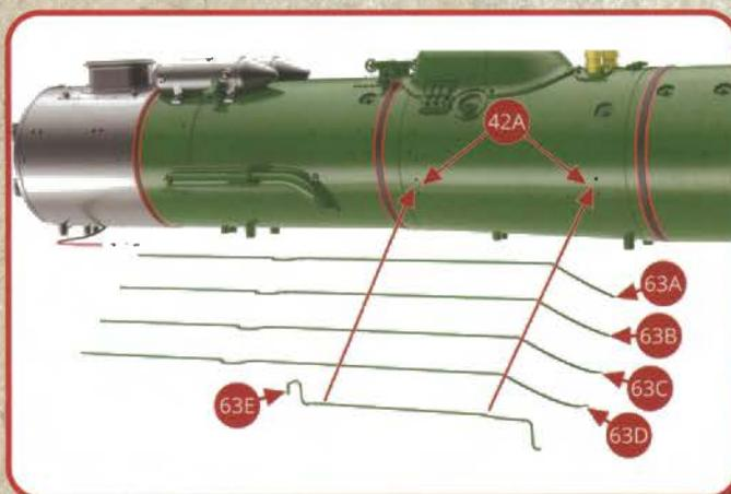
Positionnez sur la chaudière les tubulures suivantes dans l'ordre du haut vers le bas : 63A, 63B, 63C, 63D et 63E et assemblez-les avec le cavalier commun 63F et deux vis SM (voir les illustrations ci-contre et ci-dessous).
