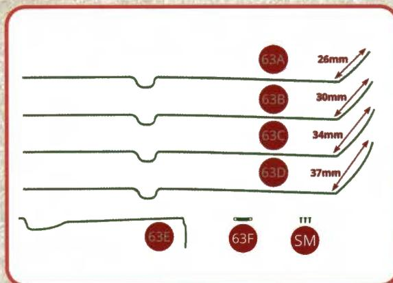
Mise en place des tubulures sur le côté gauche de la chaudière
