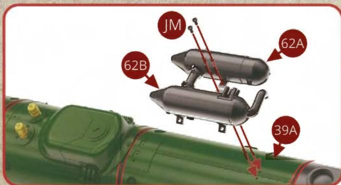
Assemblez le surchauffeur droit 62B sur la virole de chaudière 39A avec deux vis JM.
