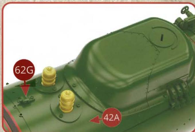
La vanne de commande 62G est en place sur la virole de chaudière 42A.
