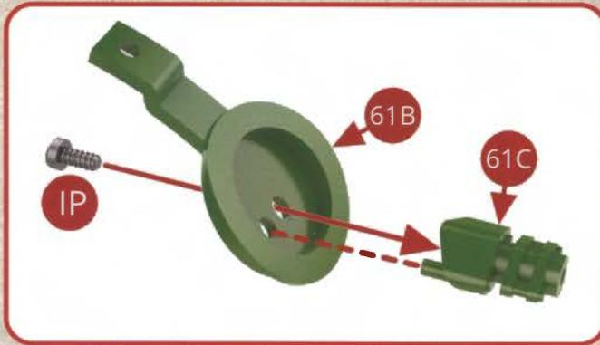
Présentez la commande de sablage 61C sur son support de commande de sablage 61B et fixez le tout avec une vis IP.
