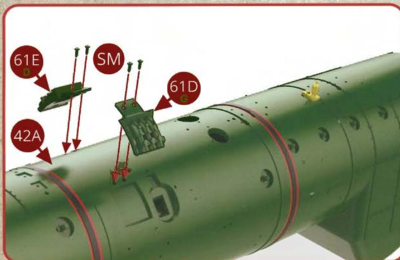
Présentez les départs des tuyaux de sablage côtés gauche et droit 61D et 61E sur le corps cylindrique de la chaudière 42A et assemblez chacun d'eux avec deux vis SM.
