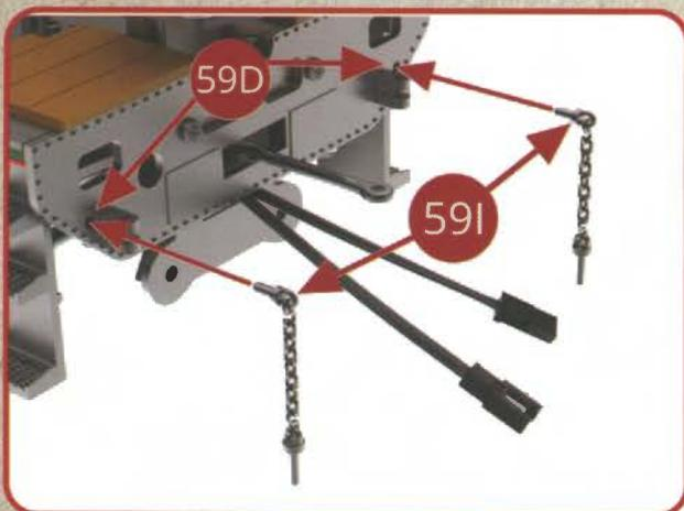
Positionnez les deux chaînes de sécurité en enfilant les goupilles 59I dans le trou de la traverse de traction 59D.
