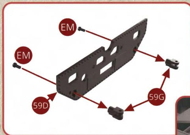
Présentez les deux mortaises 59G sur la traverse de traction 59D et assemblez-les avec deux vis EM.
