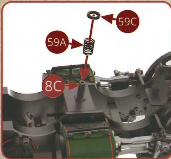
Placez ensuite le bogie avant, en le guidant par sa fente transversale de sa traverse 2A, sur la colonne de guidage 8C.
