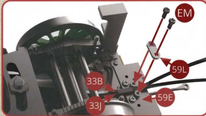
Positionnez les deux fils électriques 33B et 33J sur le support 59E et maintenez-les en place avec le cavalier 59L et deux vis EM.
