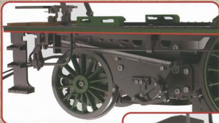
L'ensemble de la partie droite du cendrier est monté sur le châssis.
