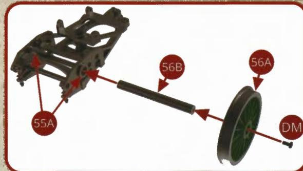
Présentez l'autre roue de bissel arrière 56A sur l'autre extrémité du corps d'essieu 56B et assemblez-les avec une vis DM.
