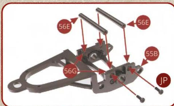
Assemblez les deux autres extrémités des entretoises tubulaires 56E sur le châssis du bissel arrière avec deux vis JP. Assemblez le renfort supérieur 56G sur le dessus du châssis du bissel arrière 55B avec deux vis EM.
