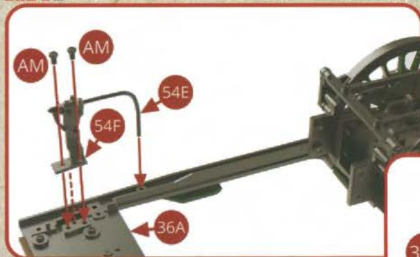
Positionnez l'ensemble formé de l'injecteur d'eau U1 54E et son support 54F sous le tablier du châssis 36A, à l'arrière droit, et assemblez le tout avec deux vis AM.
