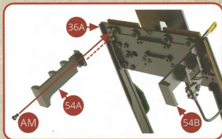
Positionnez le marchepied 54A sous le tablier du châssis 35A à l'arrière gauche, et assemblez-le avec une vis AM.
