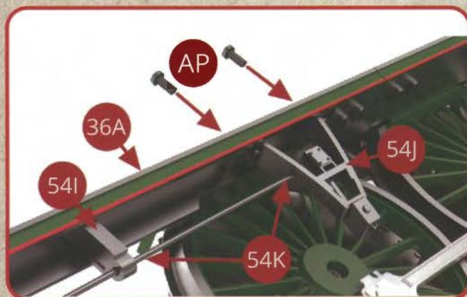
Positionnez l'autre extrémité de l'arbre d'entraînement du Flaman 54K dans la prise de mouvement du Flaman 54J et assemblez le tout sous le tablier du châssis 36A côté droit à l'emplacement prévu avec deux vis AP.
