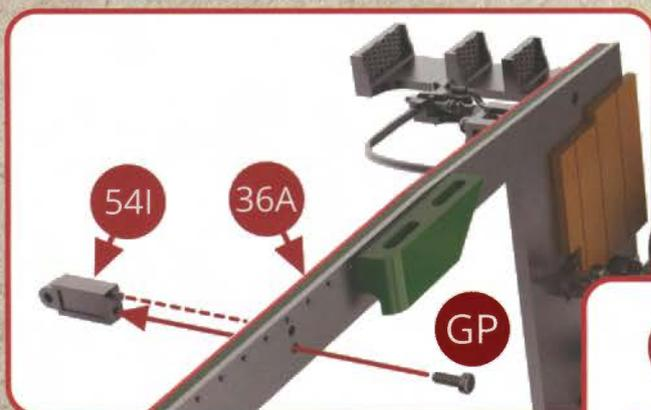
Positionnez le palier intermédiaire de l'arbre d'entraînement 54I du Flaman sous le tablier du châssis 36A à l'arrière droit et assemblez-le avec une vis GP.
