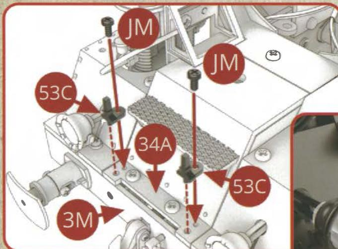
Placez les deux potences pour lanterne supplémentaire 53C sur le tablier de la traverse de tamponnement avant 34A, et assemblez chacune d'elles sur la traverse 3M avec une vis JM. Voir les illustrations ci-contre et ci-dessous.
