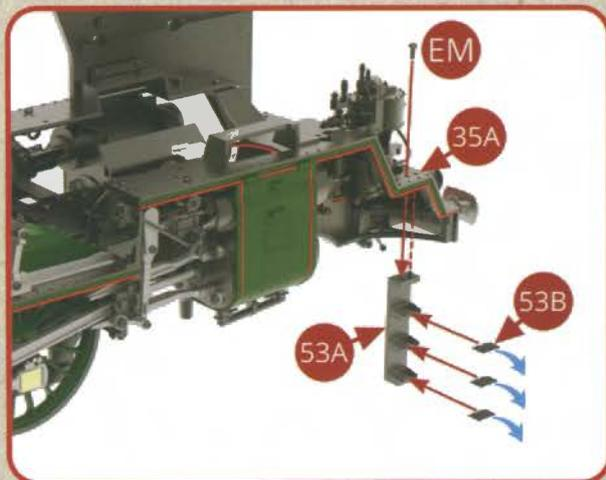
Retirez le papier de protection de trois plaques antidérapantes 53B (flèches bleues) et collez les plaques sur un des marchepieds 53A. Positionnez le marchepied 53A sous le tablier avant droit 35A et assemblez-le avec une vis EM. Voir les illustrations ci-contre et ci-dessous.
