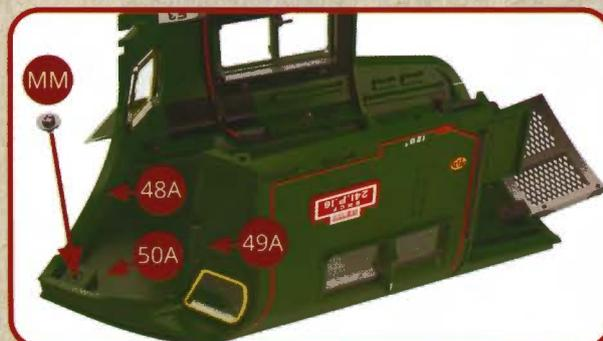
Procédez à l'assemblage de l'avant dit « coupe-vent » de la cabine de conduite en positionnant les parties obliques gauche 48A et droite 49A en les vissant avec deux vis MM à la pointe avant du toit de la cabine.
