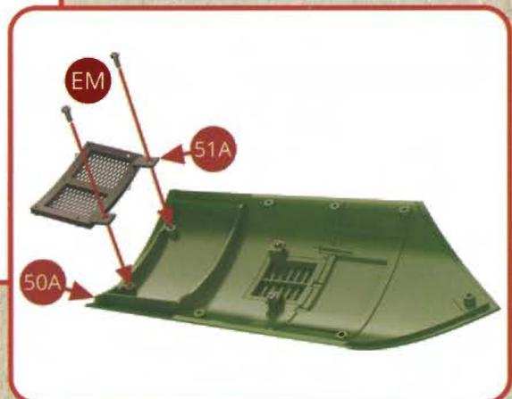
Positionnez l'ensemble 51B+51A sous le toit de la cabine de conduite et assemblez-le avec deux vis EM.
