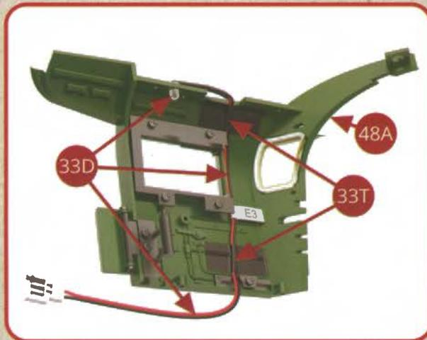
Repérez le fil E3 avec sa LED 33D du câblage électrique et placez le fil à l'intérieur du côté gauche 48A de la cabine de conduite, en poussant la LED dans son logement, et en maintenant le fil avec deux rubans adhésifs 33T.
