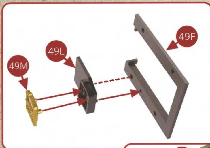
Positionnez la face avant de l'indicateur-enregistreur de vitesse Flaman 49M sur son boîtier-support 49L. Alignez bien l'ensemble et positionnez-le sur le cadre 49F.
