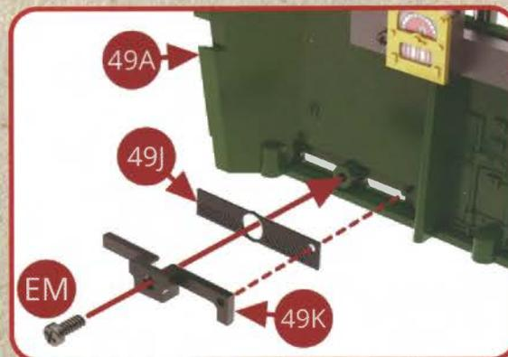
Positionnez le support 49K sur le grillage 49J et assemblez le tout contre le bas du côté droit de la cabine avec une vis EM.
