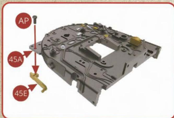
Présentez la commande du régulateur de vapeur 45E contre l'arrière de la partie haute à gauche de la devanture du foyer 45A et assemblez-la avec une vis AP.
