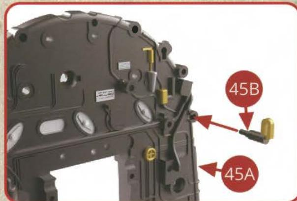
Positionnez le levier de commande de la grille du foyer 45B en enfilant son plot dans la devanture de foyer.
