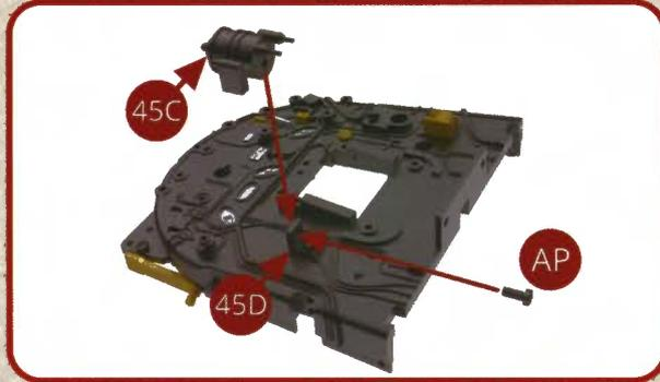
Présentez le robinet de commande de frein 45C sur le support 45D et assemblez-le avec une vis AP.
