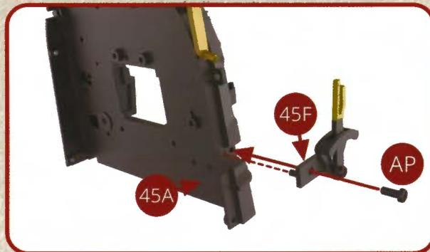
Placez l'ensemble précédemment monté 45F + 45D dans l'encoche située en bas à gauche sur la devanture de foyer 45A et assemblez-le avec une vis AP.
