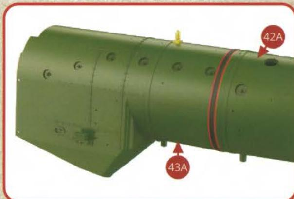
Le foyer 43A est assemblé avec la deuxième virole de la chaudière 42A, formant alors ce que l'on appelle le corps cylindrique de la locomotive.
