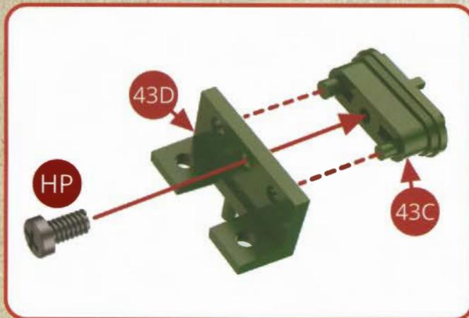
Positionnez la cale 43C et le support 43D et assemblez-les avec une vis HP.
