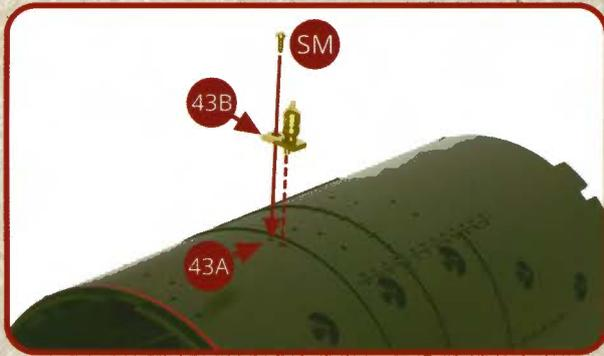
Positionnez le sifflet 43B sur la voûte du foyer 43A et assemblez-le avec deux vis SM dorées (voir les illustrations ci-contre et ci-dessous).
