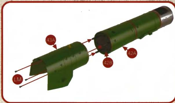
Positionnez le foyer 43A contre le renfort intérieur 42B de la deuxième virole 42A et assemblez avec trois vis LM (voir les illustrations ci-contre et ci-dessous).
