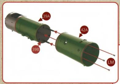
Présentez l'un contre l'autre la deuxième virole de chaudière 42A et le premier renfort intérieur de chaudière 39B et assemblez-les avec trois vis LM (voir les illustrations ci-contre et ci-dessous).
