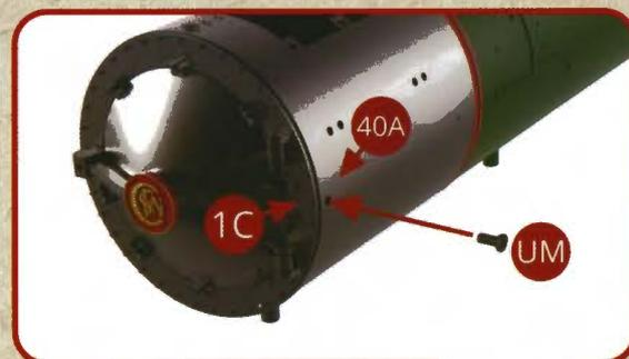
Assemblez la porte de boîte à fumée 1C sur le corps de chaudière par son côté gauche avec une vis UM.
