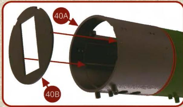
Présentez le renfort intérieur du corps de boîte à fumée dans le corps de boîte à fumée et assemblez avec deux vis SM (voir les illustrations ci-contre et ci-dessous).
