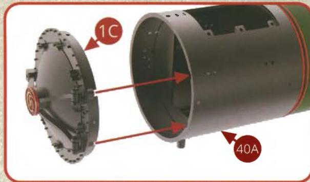
Présentez la porte de boîte à fumée 1C devant le corps de boîte à fumée 40A et engagez la porte en respectant le positionnements des « anti trompes » en saillie dans la porte et en creux dans le corps de chaudière.
