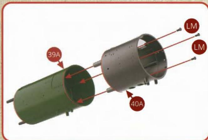
Présentez les corps de boîte à fumée et le corps de chaudière l'un contre l'autre et assemblez-les avec trois vis LM.
