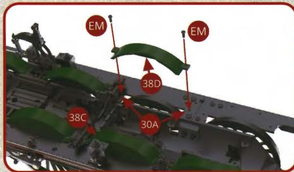
Présentez le troisième couvre-roue droit 38D sur le dessus du tablier droit 30A et assemblez-le avec deux vis EM.
