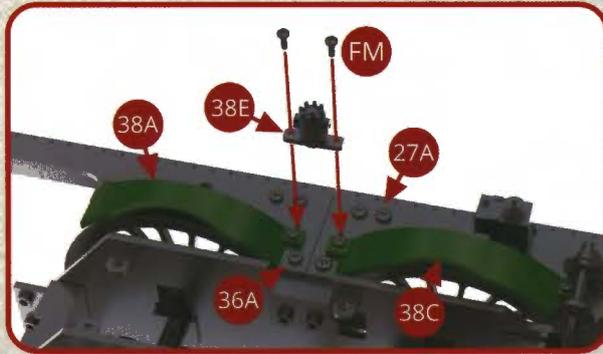
Posez la cuve de décantation 38E sur le tablier gauche 37A et aussi sur la plateforme arrière 36A, puis assemblez-la avec deux vis FM.
