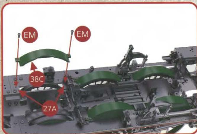
Présentez le troisième couvre-roue gauche 38C sur le tablier arrière gauche 27A et assemblez-le avec deux vis EM.
