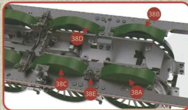
Les deux couvre-roues arrière des côtés gauche et droit sont en place sur le tablier du châssis.
