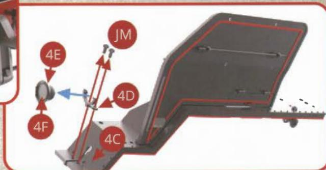
Démontez le feu avant gauche, séparez les verres 4F de la cuvette 4E, désassemblez-les du support 4D que vous retirerez du tablier avant en dévissant les deux vis JM.
