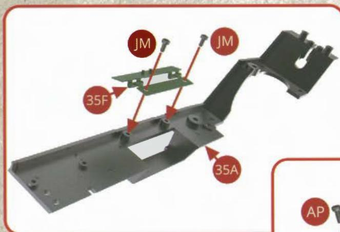
Assemblez la trappe d'accès 35F sur la rehausse de tablier droite 35A avec deux vis JM.
