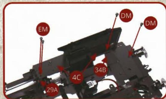
Assemblez la plateforme avant gauche 4C sur le châssis avec deux vis DM. Assemblez-la aussi sur le support 34B avec deux vis DM, ainsi que sur le tablier avant gauche 29A avec deux vis EM.
