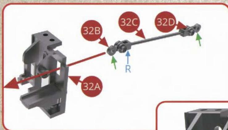
Enfilez le tirant 32C avec ses biellettes 32B et 32D dans l'orifice rectangulaire de la rehausse de tablier 32A. Alignez le trou avec épaulement de la biellette courte 32B (extrémité marquée R) en le présentant devant le pivot 32B de la rehausse de tablier (grande flèche rouge).
