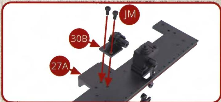
Assemblez avec deux vis JM le support de l'arbre transversal de relevage 30B sur le tablier gauche 27A.
