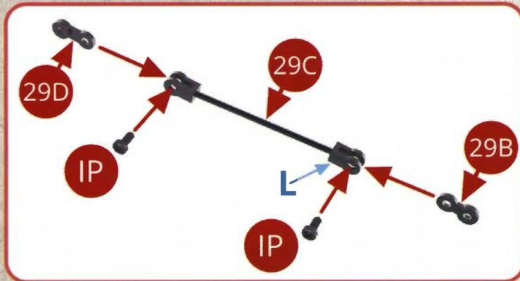
Assemblez les deux biellettes (une longue 29D, une courte 29B) à chaque extrémité du tirant 29C. La biellette courte est à positionner comme indiqué par la flèche bleue L. Fixer avec deux vis IP.
