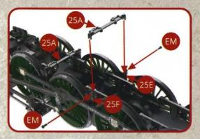
De même, avec deux vis EM assemblez les sabots de freinage gauches 25E et droits 25F à la timonerie de commande des freins 25A.
