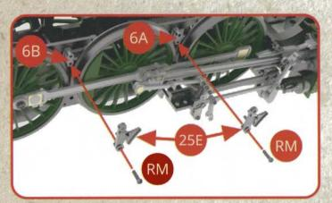
Assemblez les sabots de frein gauches 25E au longeron de châssis gauche 6A+6B avec deux vis RM.
