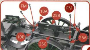
Assemblez les timoneries de freinage formées des pièces 25A, 25B, 25C gauches et droites aux supports de suspension 10A et 10B des essieux moteurs, ceci avec 4 vis FM.
