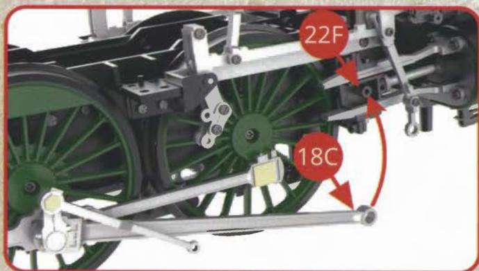
Alignez et assemblez la bielle motrice 18C avec la crosse de piston 22F.
