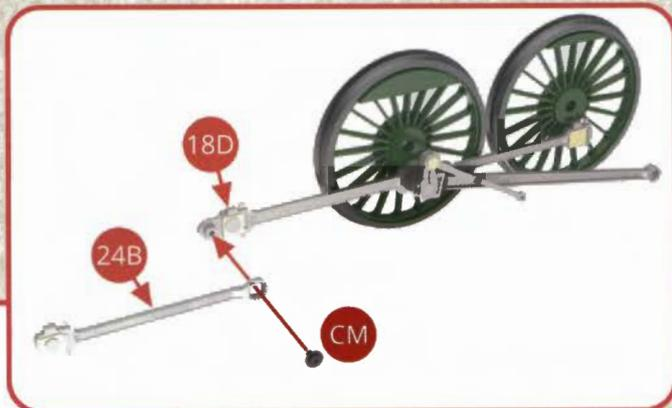
Assemblez de même la bielle 24B sur la roue 24A et la bielle 18D sur la roue 19C, toujours avec des vis CM non bloquées à fond de manière à permettre des mouvements sans point dur.
