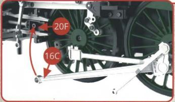
Alignez et positionnez la tête de la bielle d'attaque (dite aussi « bielle motrice ») 16C sur la crosse de tige de piston 20F.
