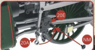
Alignez et présentez la biellette 20A sur la face avant 20E de la crosse de tige de piston. Assemblez avec une vis NM.
