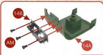
Présentez les soupapes 14B contre l'enveloppe de cylindre basse pression 14A et assemblez-les avec trois vis AM.
