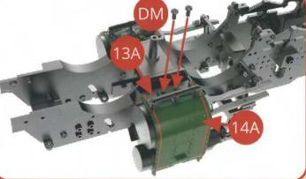
Terminez l'assemblage de l'enveloppe de cylindre basse pression et le support de cylindre basse pression avec deux autres vis DM.
