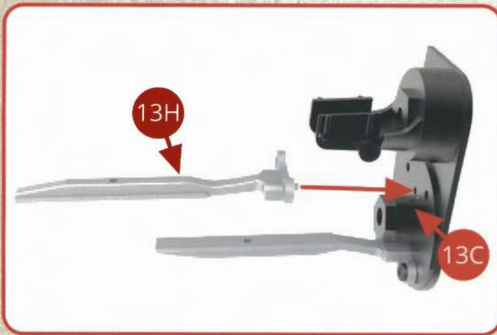
Présentez la glissière supérieure de tige de piston 13H contre la face arrière du cylindre basse pression 13C et la positionner avec son propre téton de positionnement.
