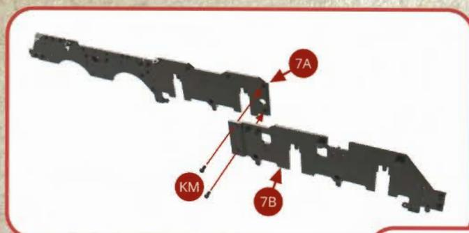
Positionnez et assemblez avec deux vis KM l'entretoise-support 7D sur la face interne du longeron droit du châssis 7A+7B.
