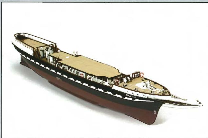
*Voici l'aspect de l'ensemble de la coque une fois cette phase de montage terminée. Mettez de côté les matériaux en excédent pour une utilisation ultérieure.*
